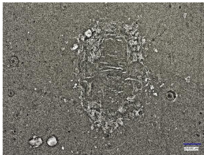
Rysunek 67. Wyniki badań tribologicznych próbki 575: współczynnik tarcia w funkcji czasu (a); profil zużycia próbki (b); trójwymiarowa topografia powierzchni śladu zużycia (c); mikrofotografia optyczna powierzchni śladu zużycia (d)
