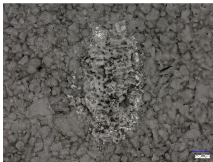
Rysunek 70. Wyniki badań tribologicznych próbki 575_HAp/Kol-w: współczynnik tarcia w funkcji czasu (a); profil zużycia próbki (b); trójwymiarowa topografia powierzchni śladu zużycia (c); mikrofotografia optyczna powierzchni śladu zużycia (d)
