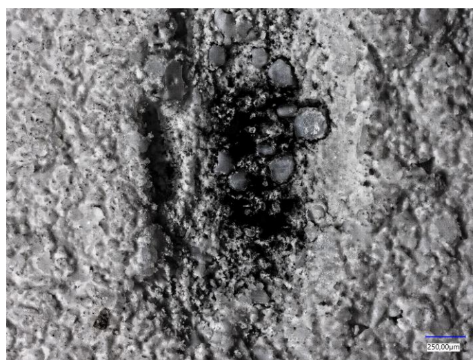
Rysunek 68. Wyniki badań tribologicznych próbki 575_HAp: współczynnik tarcia w funkcji czasu (a); profil zużycia próbki (b); trójwymiarowa topografia powierzchni śladu zużycia (c); mikrofotografia optyczna powierzchni śladu zużycia (d)
